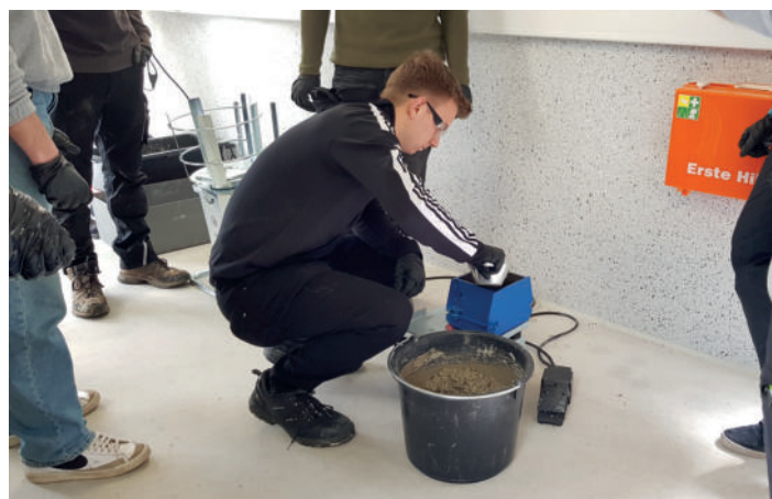
Herstellung von Probekörpern zur späteren Prüfung der Druckfestigkeit
