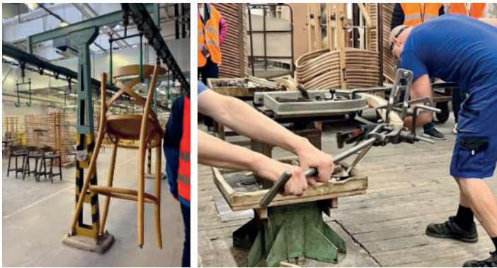
Fertigungsstraße im Lackierbereich und Biegetechnik von Vollholz bei Ton
