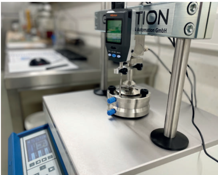
Universalprüfgerät zur Durchführung von kraft-, weg-, geschwindigkeits- und steifigkeitsgeregelten Versuchen
