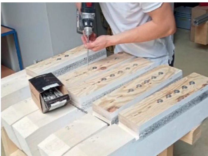
Vorbereitung von Versuchskörpern für die Prüfung des Holz-Beton-Verbundes
