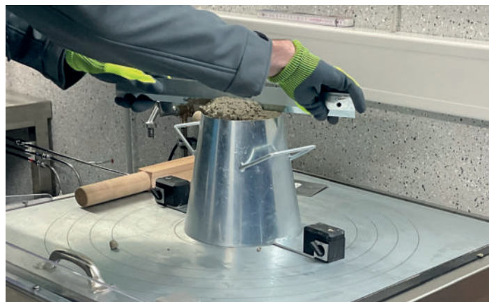
Prüfung des Ausbreitmaßes von Frischbeton
